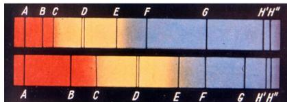
Die Fraunhofer’schen Linien („bands of deficient action“) sind schwarze Linien im farbigen Spektrum des Sonnenlichts, die schon Joseph Fraunhofer 1824 beschrieb und mit Buchstaben „B, C, D, E, F, ..“ markierte. Er fand, dass ihre spektrale Lage und Zahl vom
